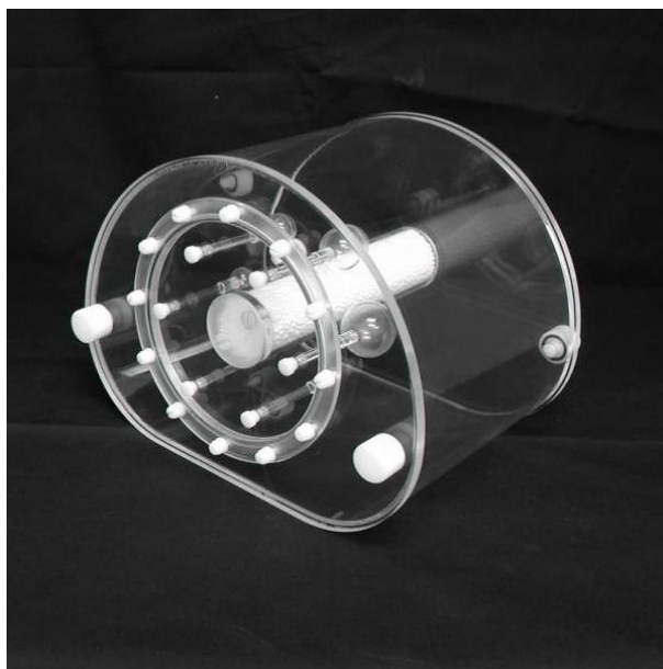
Rysunek 9: Fantom NEMA – plastikowy model płuc służący do badań nad tomografią PET.
